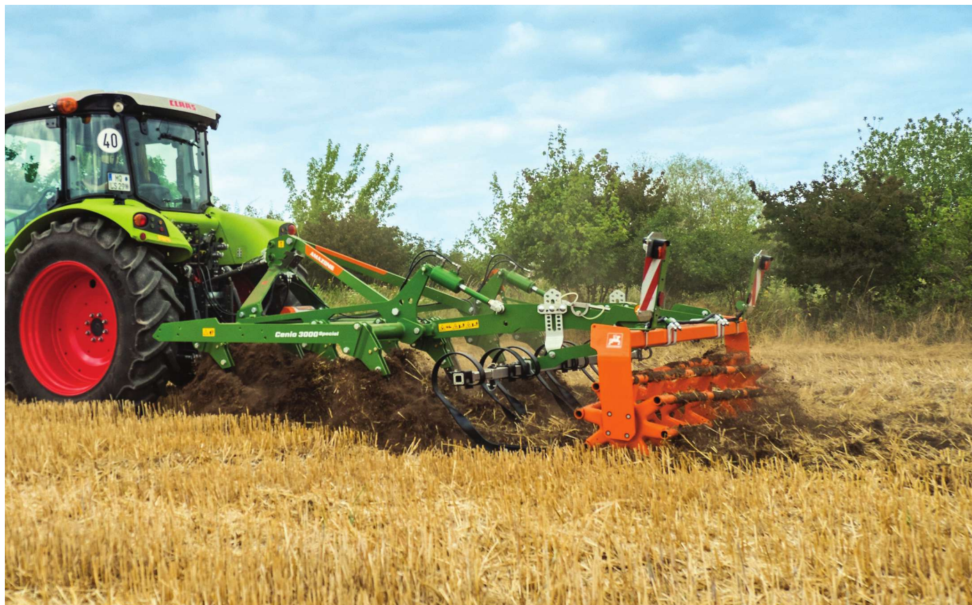
Cenio 3000 Special z elementami sprężystymi i wałem rurowym SW.
