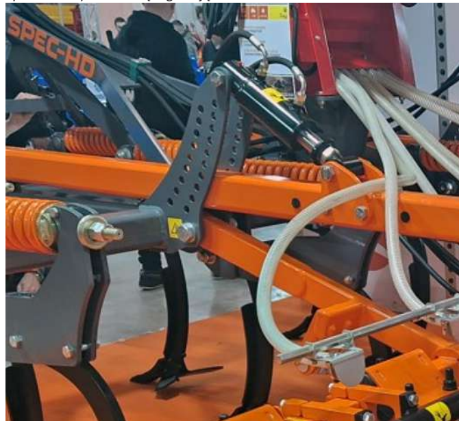
Spec HD z hydrauliczną regulacją w standardzie.
