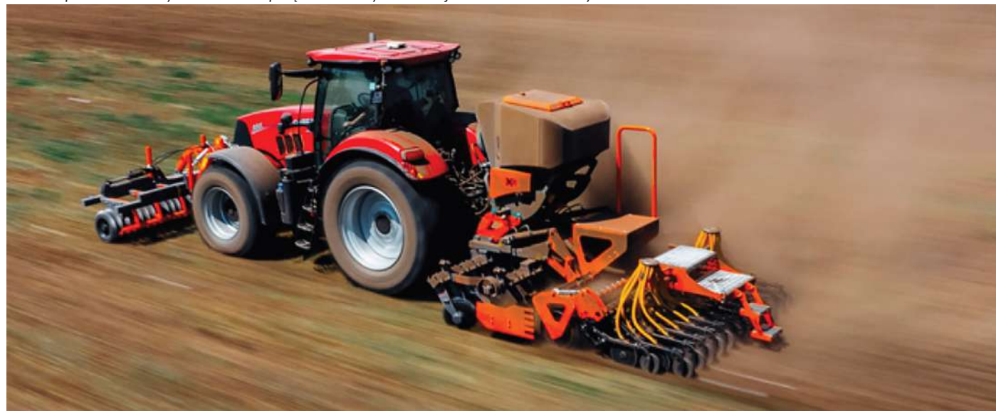
Zestaw uprawowo-siewny Gal Combo to połączenie brony talerzowej z siewnikiem zbożowym.
