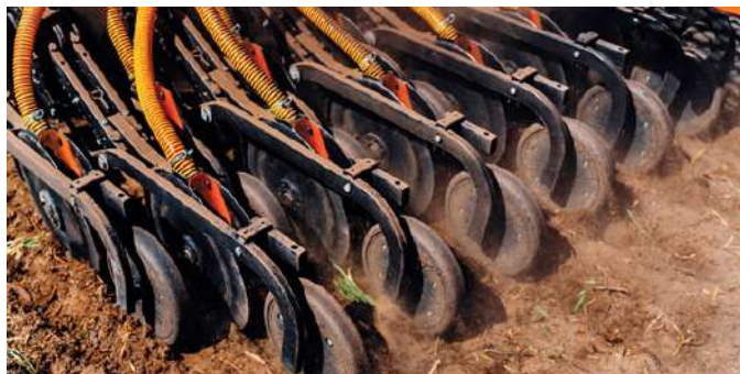
Zestaw uprawowo-siewny Gal Combo to połączenie brony talerzowej z siewnikiem zbożowym.
