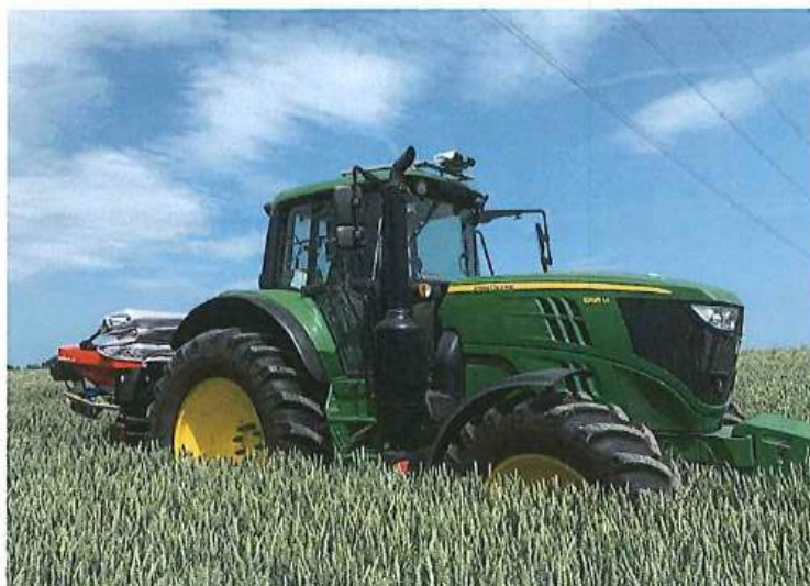
Rysunek 18. Zestaw do mapowania łanu - system Augmenta na ciągniku JD (źródło: EPLi Agri MORO, autor)
