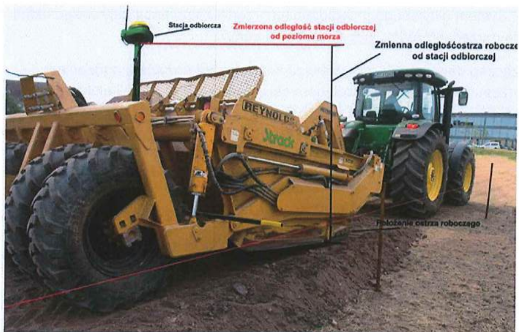
Rysunek 6. Przykład rozwiązania pozycjonującego pionowe położenie narzędzia (Ekielski, Wesółowski, 2019).
