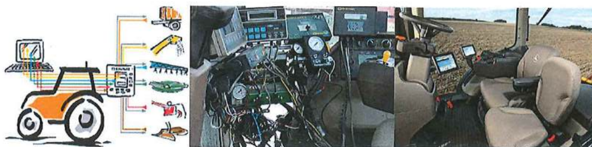
Rysunek 21. Idea przyświecająca twórcom systemu ISOBUS – kompatybilność urządzeń dostarczanych przez różnych producentów – jeden uniwersalny terminal do sterowania wszystkimi maszynami współpracującymi z ciągnikiem
