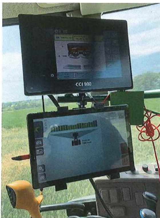
Rysunek 14. Technologia nawożenia mineralnego zmienną dawką z zastosowaniem obrazowania multispetralnego (źródło: EIP AGRI MORO, autor)
