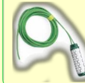
Tensiometr badający rzeczywiste napięcie wody w glebie (mierzy wysiłek pobierania wody przez rośliny)
