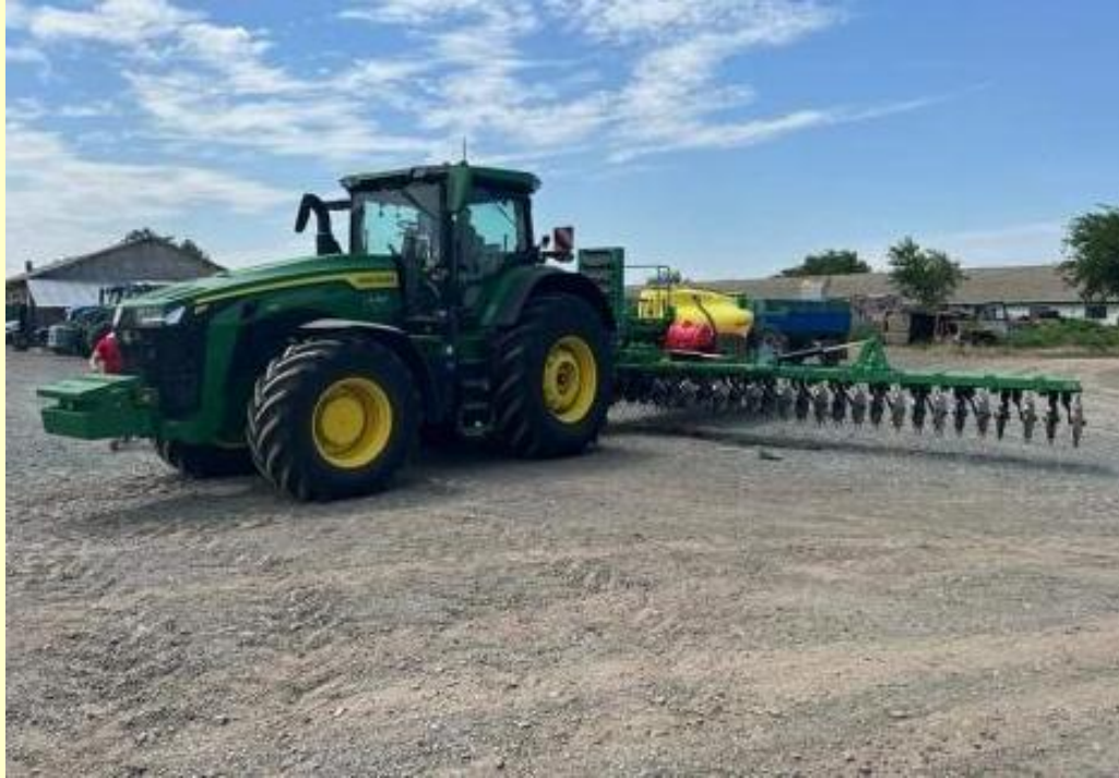
Iniektor nawozów płynnych YUKON 3000.12 z GPS
